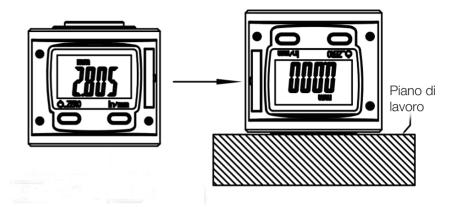
Appoggiare lo strumento sul tavolo di lavoro, avvicinare l'utensile alla superficie di contatto e dell'azzeratore finchè non si raggiunge il punto 0. Una volta raggiunta la posizione 0 il display si illumina. La posizione esatta è stata impostata.
