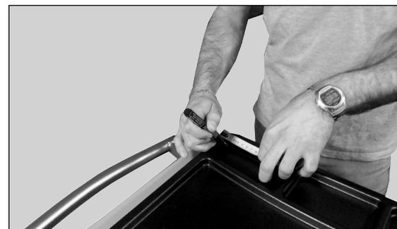
Riportare sul ripiano termoformato le misure appena rilevate
