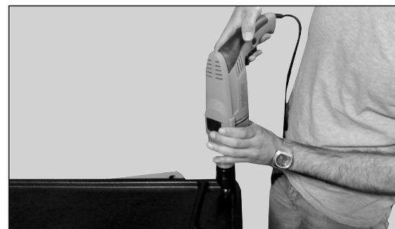
Utilizzando il trapano eseguire un foro da 16 mm con una punta a gradino F 7596 5020
