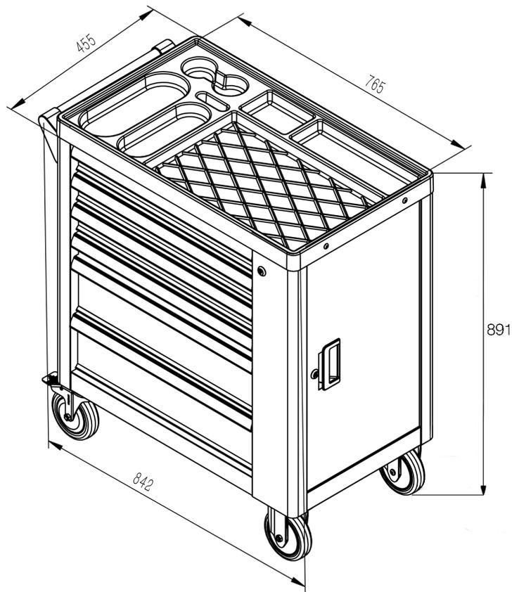
» Dimensioni di ingombro max. del carrello LxPxh 842x455x891 mm (inclusi maniglia e ruote)
