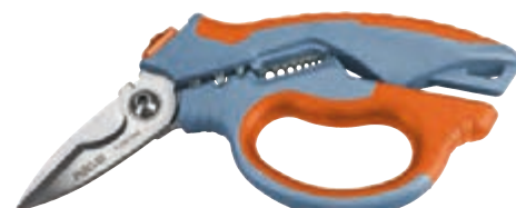
Con tronchese, 2 inserti per crimpare terminali 2,5 e 6 mm 2 e tacche spelacavi per conduttori da 0,3 a 6 mm 2
